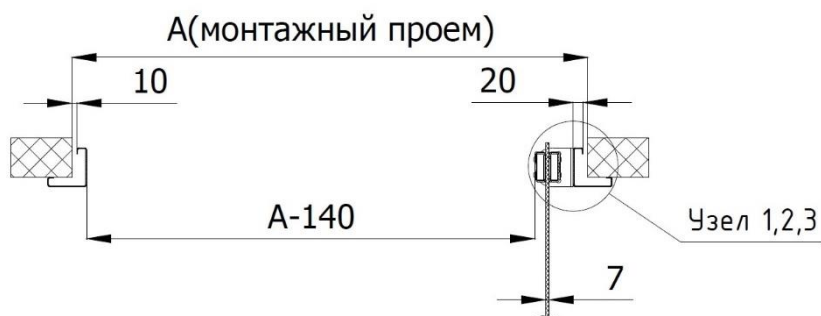
Рисунок 9. Разрез А-А. МДО ПВХ с «угловой» рамой в открытом положении
