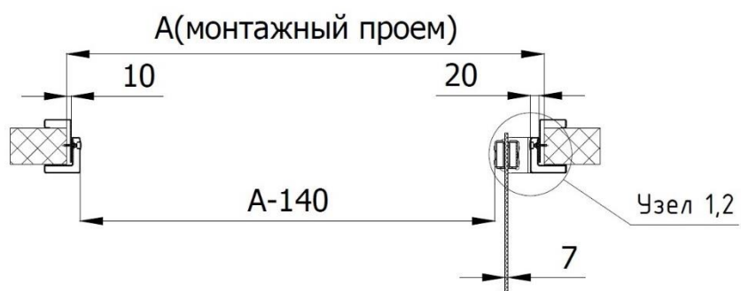
Рисунок 22. Разрез А-А. МДО ПВХ с рамой «в обхват» проема в открытом положении
